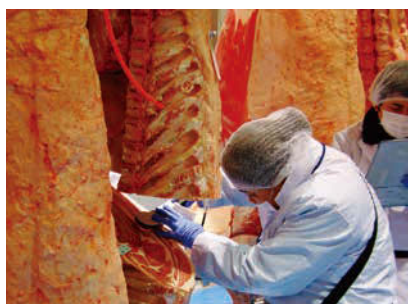
食肉脂質測定装置を使えば、牛肉に含まれる「オレイン酸」などを冷蔵庫内で測定できる
