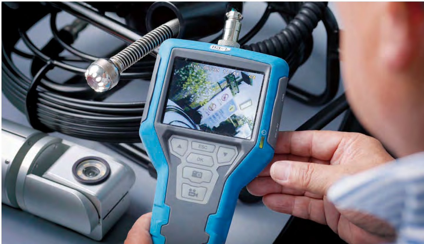
「細径配管点検用パイプカメラ」のケーブルは最長70mに及び、狭くて暗い場所でも、観察したい場所をきちんと確認できる
