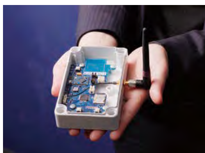
無線振動計測システム「sonas xシリーズ」のセンサユニット
