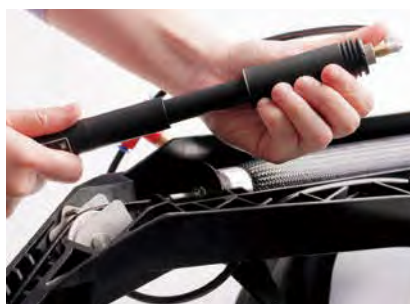
ゴムチューブの中に圧縮空気を入れた「人工筋肉」がバネのように元に戻ろうとする力を利用し、アシスト力を得る仕組みだ
