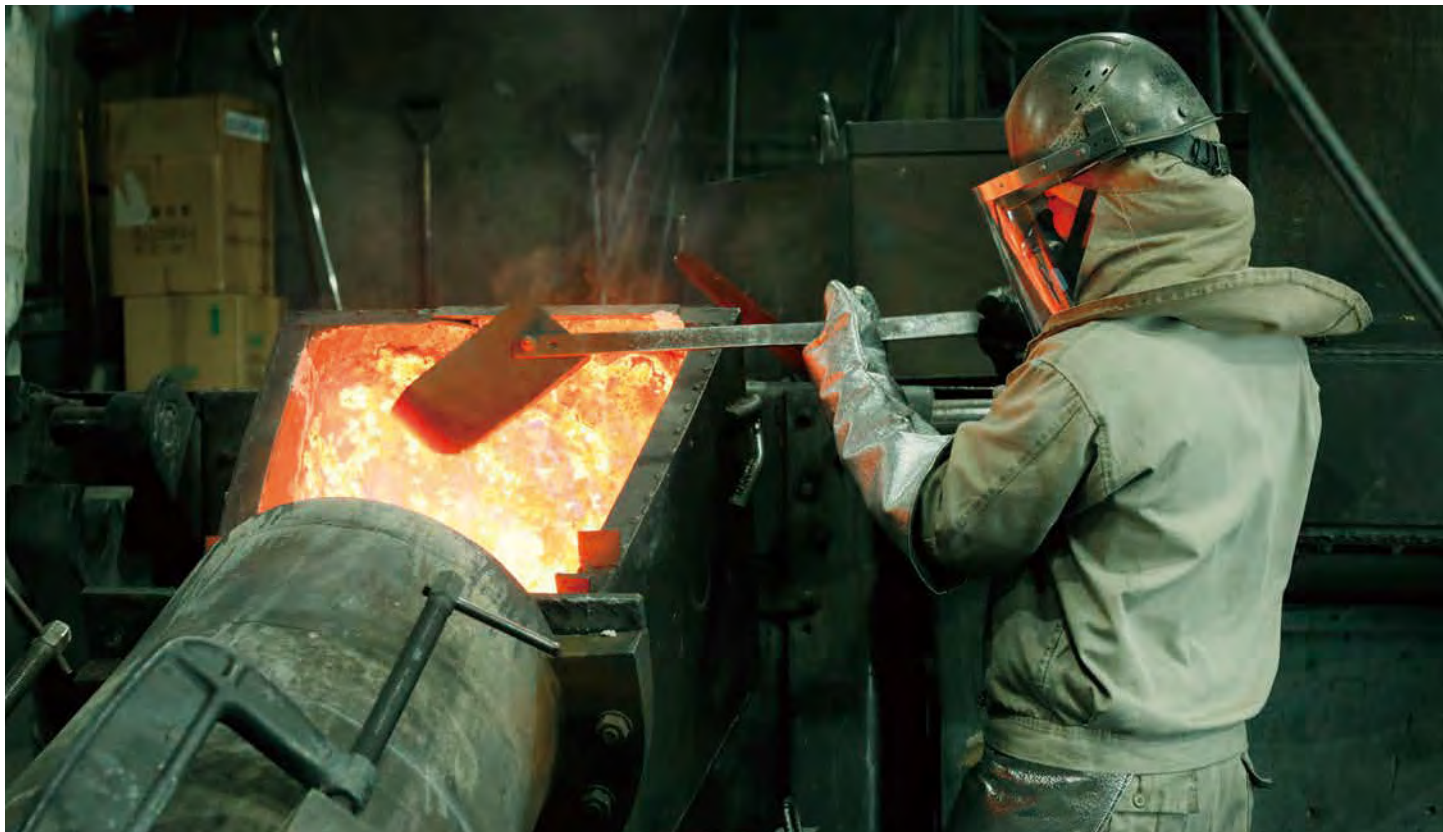
溶かした銅合金を鑄型に流し込んでいる様子。中小企業の場合、鑄造、鍛造、加工などいずれかの工程に特化した企業が多いものだが、大和合金、三芳合金工業では全工程を一貫して行えるのが強みだ
