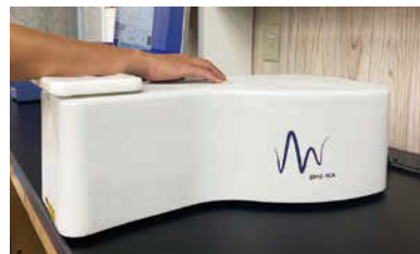
図3 in vivo共焦点ラマン分光装置 塗布した化粧品の皮膚への浸透性や深度を評価できる装置
