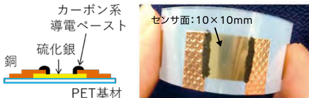
図1 フレキシブル光導電センサ
