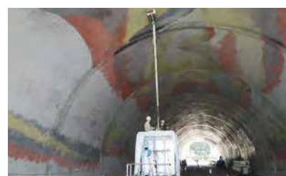
詳細診断状況 (接触型電磁波覆工背面調査)
