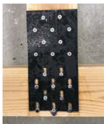
引張試験後のAIプレート
