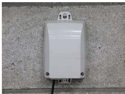
LPガスの遠隔検針に使われるデバイス。このような機器が普及すれば、建設・インフラ・農業など幅広い分野で省力化が実現できる
