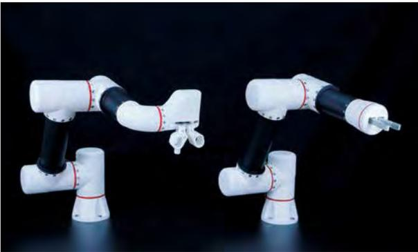
慶應義塾大学との共同研究により開発した、マスタースレーブ操作型ロボットアーム「ハプティクスプラットフォーム」
