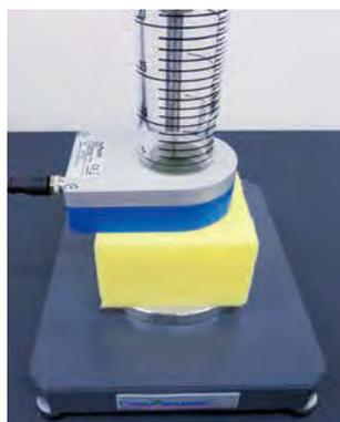
図2 試験片設置風景
