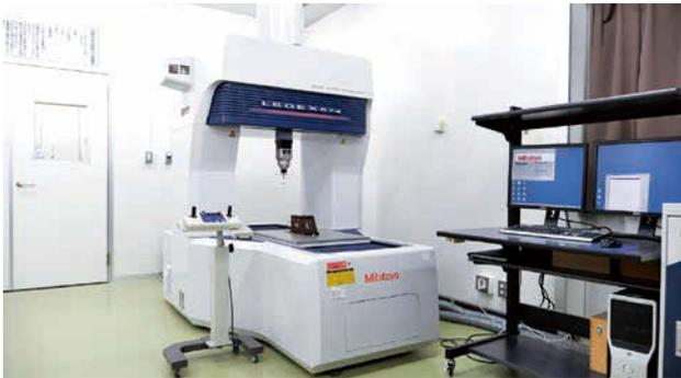
三次元座標測定機は、X、Y、Z軸方向にそれぞれ独立した測長スケールを持った測定機で、機械部品などの長さ、角度、輪郭形状、幾何偏差などを接触式により測定が可能です。門固定・テーブル移動構造により誤差要因を排除し、高精度の測定を実現する測定機です。
