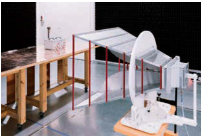
図1 車載機器向け放射イミュニティ試験 ISO 11452-2
