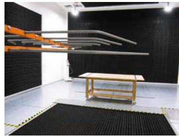
図2 民生機器向け放射イミュニティ試験 IEC 61000-4-3
