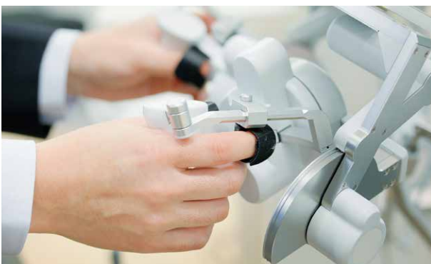
グリップ(操作部)が「力覚」や操作感などの感触を安定して伝えることで、手術においてより細かく正確な操作が可能に
