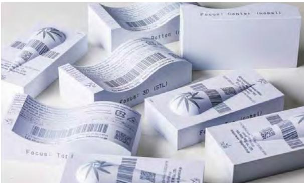
3Dレーザーマーキングの技術を使えば、曲面にも印刷加工が可能。工夫次第で面白いモノが作れそうだ
