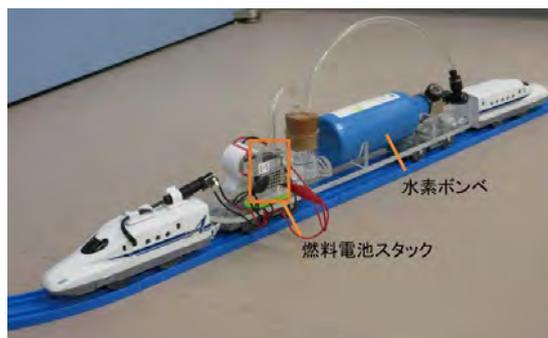
図2 燃料電池で動く電車玩具
