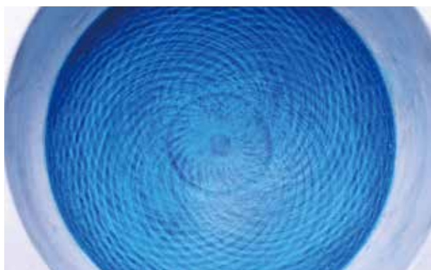
乳棒の軌道を分かりやすく表示した乳鉢の様子。むらなく乳棒を動かすことで、様々な材料を均一に混ぜ合わせることができる
