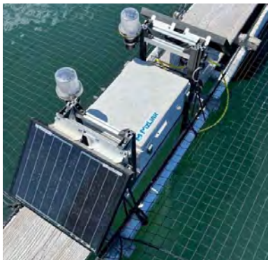
海洋観測システム「MizLinX Monitor」。養殖給餌の最適化、魚病・赤潮の検知など養殖いけすの状態をリアルタイムでモニターできる
