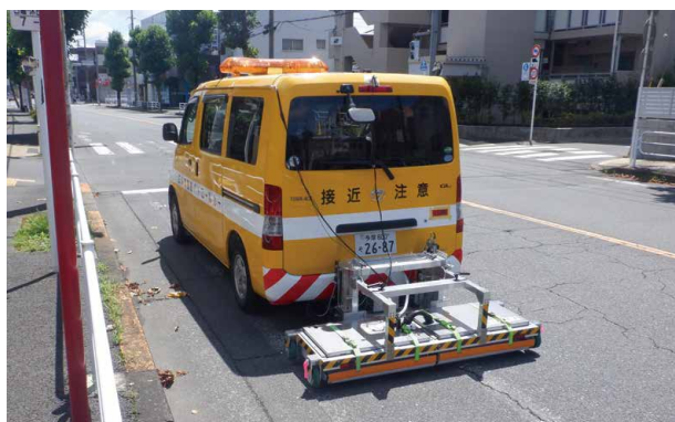
道路パトロールカーに装着し、日常のパトロールをしながら路面下の空洞を調査できる「キャリア積載型地中レーダシステム」
