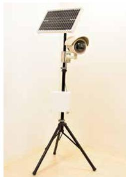
通信線・電源線が不要のため、災害時にインフラが寸断されても災害現場の情報を送ることができます。また温度-10℃~+55℃、湿度20%~80%、IP55相当の厳しい環境条件でも動作が可能です。
