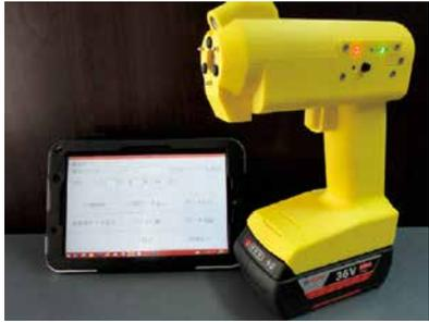
当社は生産管理・プラント制御システムの構築や音・振動計測による予防保全装置とRFIDソリューション等の各分野における開発支援を行ってまいりました。そのノウハウを生かし、社会インフラ保守管理の省力化のために、従来ハンマーと検査員の聴力での打音検査を、誰でも検査可能な打撃装置により、収集したデータを自動判定する打音検査システムを開発しました。装置は持ち運びでき、リアルタイムで構造物の欠陥を判定し、経年データの記録を取る事が可能です。
