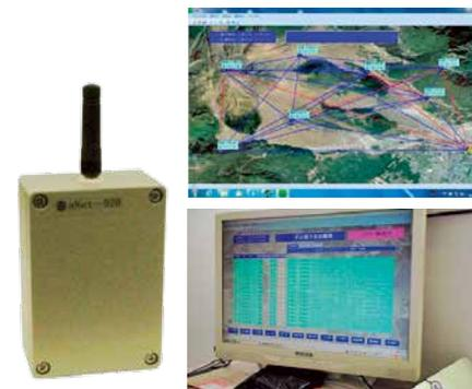
マルチホップ無線で広域に複数の傾斜センサー、ワイヤーセンサー、雨量センサーなどを設置し、離れた管理所のパソコンで集中監視ができます。特定小電力無線で伝送距離は見通しで約1kmを確保、電池式で電源配線も不要です。累計雨量と強度雨量、実効雨量の監視が可能で、任意設定の警戒値以上で警報をパソコンに発報します。
