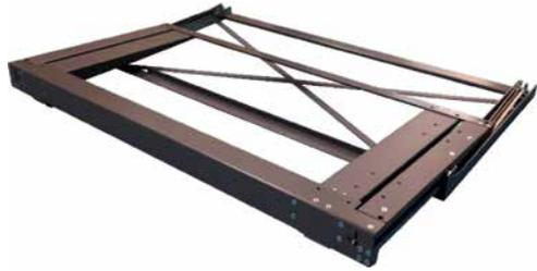
地震時、搭載物の転倒を防ぎ、さらに収納物の落下も防止する装置です。搭載物が前に倒れそうになると、スライド機能で搭載物が後傾斜状態になります。収納物を落とさないで、人を守り、避難経路を確保します。既存のベースを「Antigal-Glide」に付替えるだけで、付け替えるだけで、転倒・落下リスクが大幅に低減可能です。
