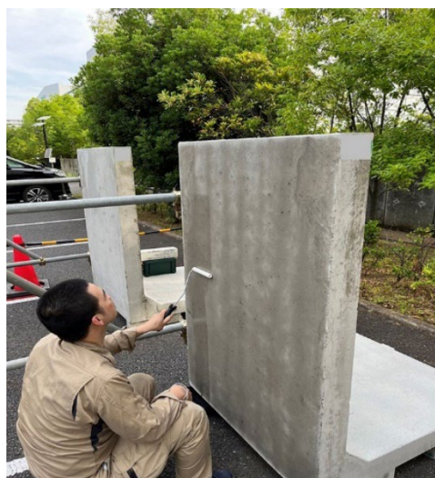
図表 46. 塗るだけでコンクリートの CO 2 固定化を促進する塗料 (出典 5)
