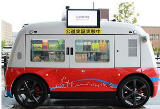
図表 58. 荷室が設計された移動販売用の 中速・中型ロボット（出典 4）
