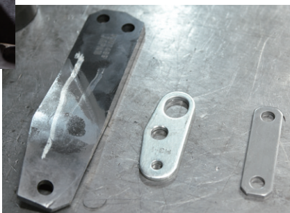
プレスでの抜き加工。従来機と比べ加工の精度とスピードが大幅に向上した(写真上)。当社が製造したブラケットや継手、加工公差±0.1mmの精度まで実現可能(写真右)
