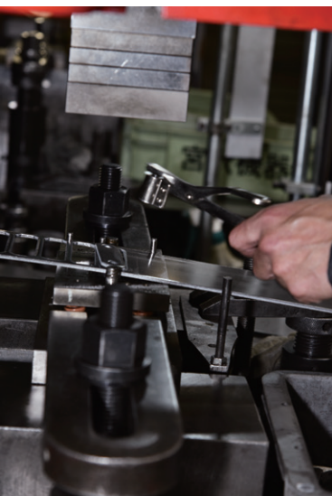
プレスでの抜き加工。従来機と比べ加工の精度とスピードが大幅に向上した(写真上)。当社が製造したブラケットや継手、加工公差±0.1mmの精度まで実現可能(写真右)
