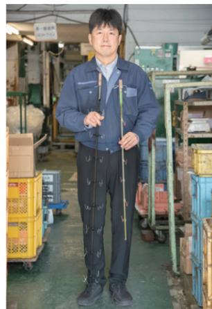
従来機の治具（向かって右）と新設機の治具（同左）。新設機はめっき槽が深くなった分、一度に加工できる処理量が増えた。
