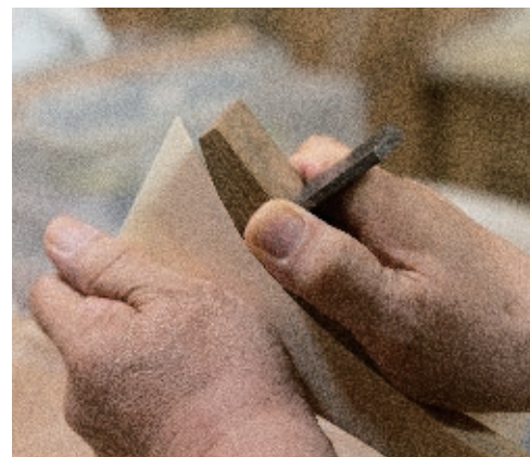
かな 特製の鉋でバチの美しさを蘇らせる
