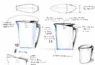
初期のスケッチ。容器を上から持ち上げる際の持ちやすさを考えた外形の幅、操作法がすぐ分かるフタの形、手になじむハンドル部分の断面などを検討している
