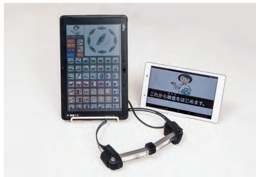
胃部X線検査支援システム「e-検査ナビ」は、検査者がタブレット端末を操作して検査の指示を出し、被検者はヘッドマウントディスプレイまたはモニターに表示された検査指示を見て、スピーカーから流れる音声聞いて検査を行う仕組み
