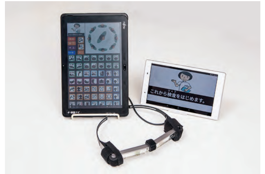
胃部X線検査支援システム「e-検査ナビ」は、検査者がタブレット端末を操作して検査の指示を出し、被検者はヘッドマウントディスプレイまたはモニターに表示された検査指示を見て、スピーカーから流れる音声聞いて検査を行う仕組み
