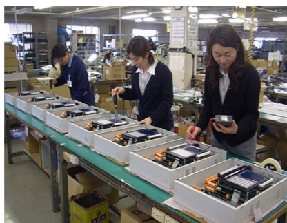
組立配線(ユニット)
