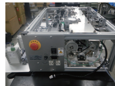
フィルム耐久試験機(携帯電話向け) 設計→機械加工→組立→調整
