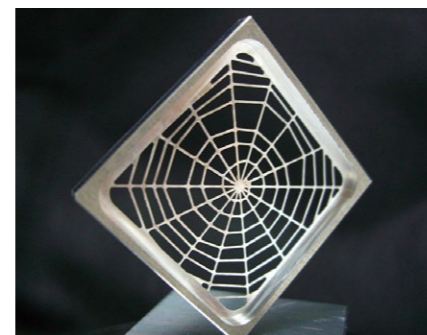
素材：A7075/ t=3mm/幅200μ m×厚さ200μmの クモの巣形状加工 材質：C3604B(真鍮)
