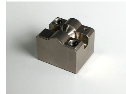
エレキベース用サドル 加工：マシニング 材質：純チタン サイズ：16×19×15
