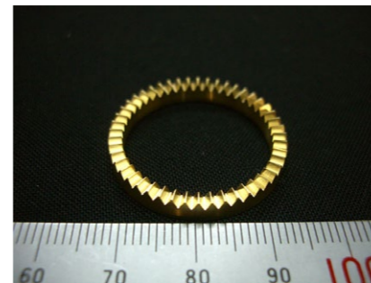
リングギア 加工：旋盤 + マシニング 材質：真鍮(C3604B)
