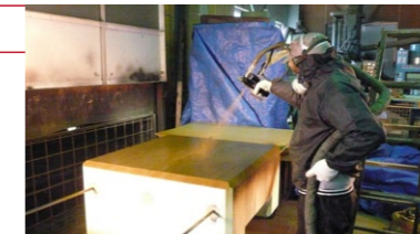
ダム用フロート(発泡スチロール)への防水コーティング
