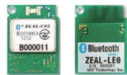
Bluetoothシリアルモジュール (OEM製品：ZEAL-CO2, ZEAL-LEO)
