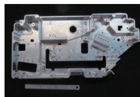
大きいサイズの加工事例。規格公差 1/100 を精度保証
