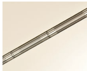
針状の基材の側面に 電極形成が可能
