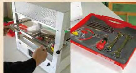
開発製品「V.former」。上部ヒーターでシートを熱し、下部から真空吸引する。型がなくても現物でプラスチックシートを成形することができる。
