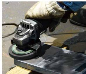
⑤カットされた鉄板の溶断面を丁寧にバリ取りします。
