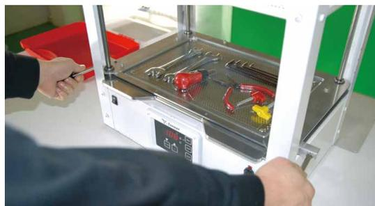
プラスチックを熱で加熱し成形
