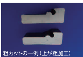
CFRP（炭素繊維強化プラスチック）カットの一例
