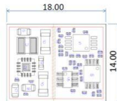
(b) 試作モジュールモジュール寸法図: 単位: mm 2
