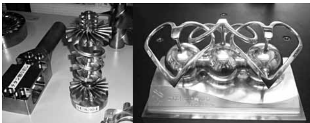
五軸マシニングセンターで加工された複雑な形状の製品
