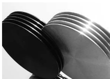
φ52丸棒材を切り出したヒートシンク(放熱器)。 フィンの厚さ0.8mm、フィンの間隔2.7mm、溝深さ17.5mmである
