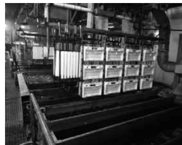
本社工場自動めっきライン
