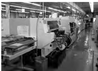
下仁田工場プリント基板実装ライン
