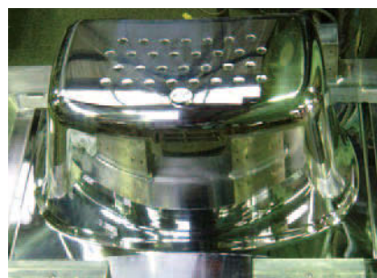
バスタブをつくる金型にめっき処理を施したところ。技術力の高さは、顧客からの評価も高い
