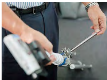
「高所撮影Jidoribo-Pro」は首振り調整がしやすく、360度回転可能なので現場で使いやすいと好評
