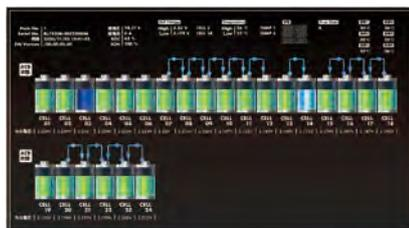
電池の状況を離れた場所から確認したり、劣化の具合を見て最適な電池交換のタイミングを予測したりすることも可能だ
