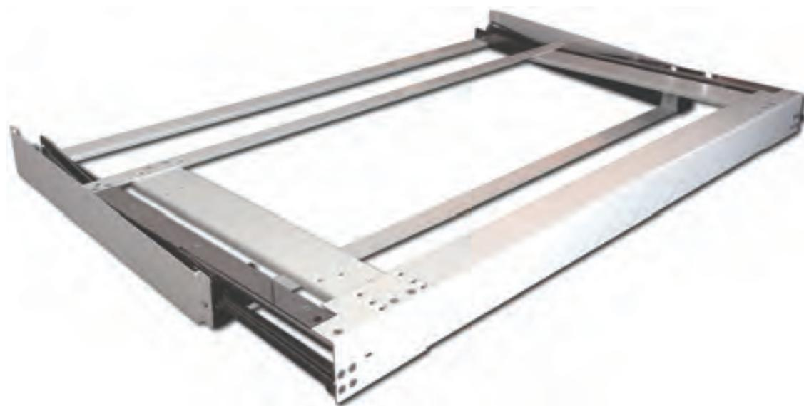
地震時、搭載物の転倒と収納物の落下も防止する装置です。搭載物が前に倒れそうになると、スライド機能で搭載物が後傾斜状態になる機構です。収納物を落とさないのので、人を守り、避難経路を確保します。既存のベースを「Antigal-Glide」に付替えるだけで、床・壁固定よりも確実な転倒・落下防止対策が可能です。
