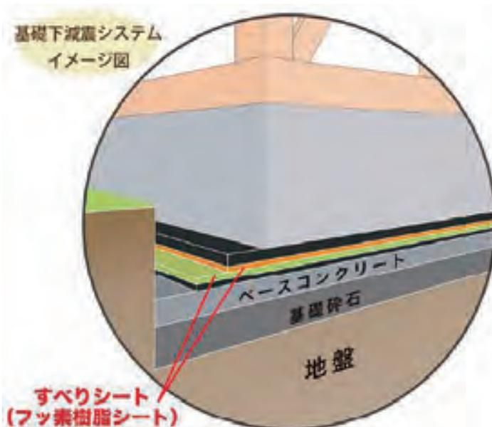
TBSテレビの「緊急!池上彰と考える巨大地震」で紹介されました。建物のベタ基礎と地盤側との間にすべりシートを全面敷設し、震度7の地震動に対し、建物の揺れを震度5強に低減することが出来るシステムです。
