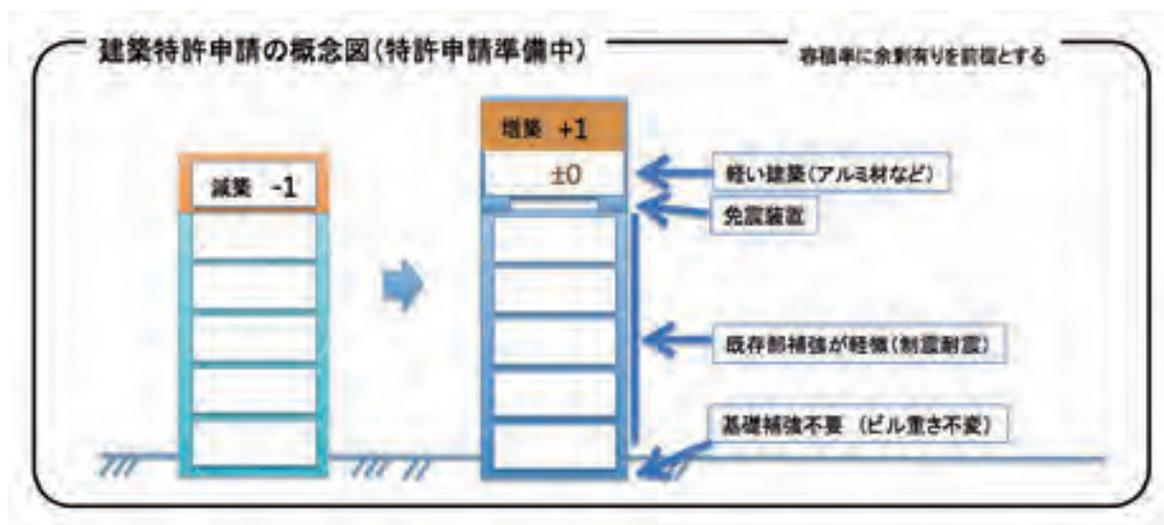
全く新しい耐震改修技術を提供します。従来のビル自重と変わらない増築を行い、かつ、増築居室を重りとして利用する事で、既存部と増築部が地震の揺れを相殺し合う原理を持つ、制震化による耐震改修技術になります。従来の耐震改修に比べ「改修箇所が少なくなる」という経済メリットや、増築による「収入増」をビルオーナーに提供します。
