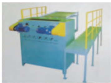
太陽電池パネルモジュールからガラスを剥離する装置。
