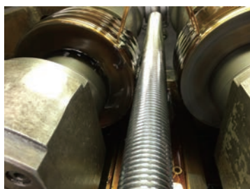
熟練した職人が大型転造盤を使って製作しています
